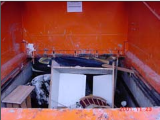
MAKRO-TYPE für Sperrmüll mit Nettobefüllöffnung 1,9 x 2,0 m MAKRO-TYPE for bulky waste – clear-feeding-aperature 1,9 x 2,0 m
