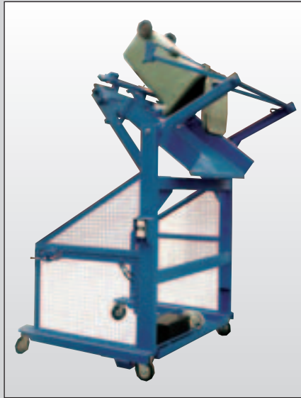
Mobile Hubkipp-Vorrichtungen für Sammelbehälter. Mobile loaders for a variety of bins.
