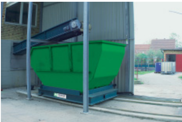
Filterkuchenförderanlage mit Verschiebeeinheit zur optimalen Befüllung der Mulde
