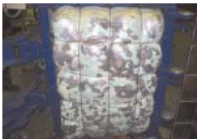
Die Kreuzverschnürung ergibt einen formstabilen Ballen.
