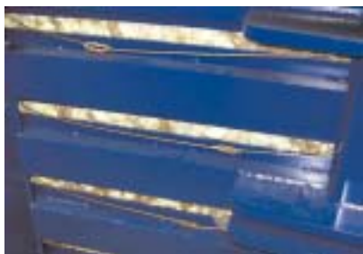
Manuelle Abbindung mit Schnellverschlussdrähten.
