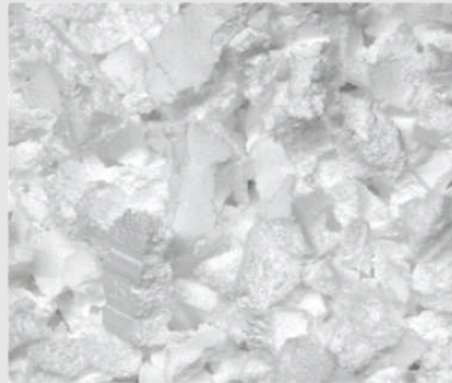
Zerkleinertes EPS (Größe ca. 20-40 mm)
