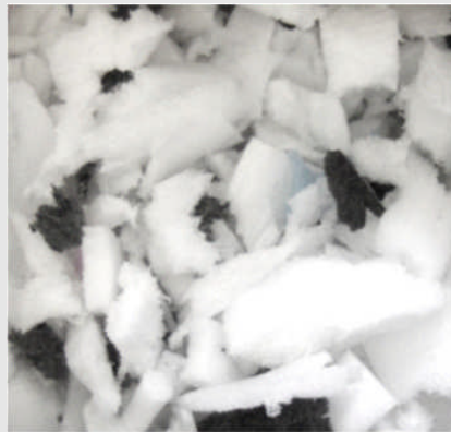
Zerkleinertes EPE (Größe ca. 20-100 mm)
